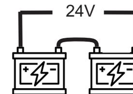
Seu equipamento funciona com 24 volts. Use duas baterias para conseguir essa voltagem. Use o cabo menor para conectar as baterias como demonstrado na imagem. O cabo que conecta o nobreak a bateria deve ser ligado nos outros terminais conforme a sua devida polaridade. Cabo vermelho para positivo e preto para negativo.
